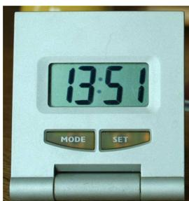
Exemples (très simples, pour ne pas dire simplistes) : Le réveil de la figure 1, programmé pour sonner à une heure précise sans prise en compte de l'environnement est un **automate**, alors que le thermostat de la figure 2 qui pilote l'installation de chauffage en fonction de la température de la pièce est un **robot**.
