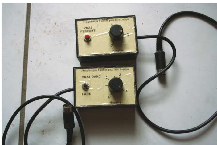
D'autres périphériques sont réalisables (capteurs de température par exemple) en utilisant le même principe du pont diviseur de tension.
