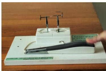
Avant de passer aux dangers de la foudre, on peut montrer le fonctionnement de ce générateur en installant deux pointes espacées d'environ 1 cm et en actionnant le générateur.
