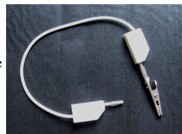
Attention : avant de toucher les électrodes, décharger l'appareil en court-circuitant les deux porte-électrodes avec la lame d'un tournevis ou avec un dispositif comme celui montré sur cette photo :
