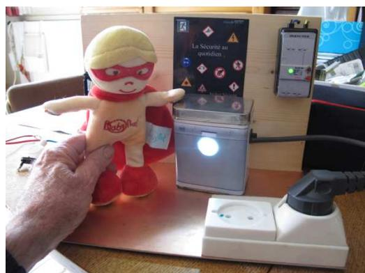
Débranchez l'appareil, mettez le bouton « défaut » sur « oui » pour simuler un contact accidentel entre le fil de phase et la carrosserie, puis rebranchez l'appareil sur la prise avec terre.
