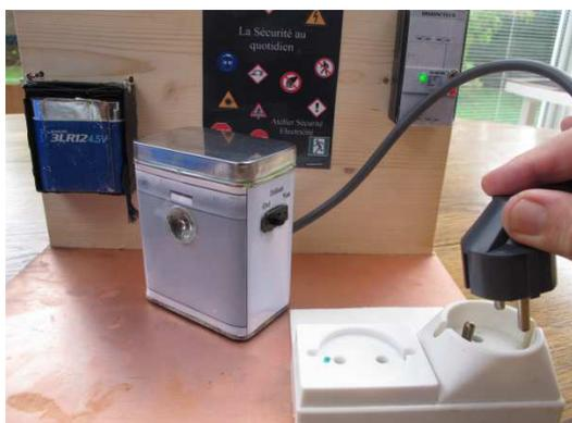
Armez le disjoncteur branchez la maquette de lave-linge (bouton « défaut » sur « non ») sur la prise avec terre. La DEL blanche du lave-linge s'allume, signalant le fonctionnement de l'appareil. On peut placer la main de la peluche sur le dessus de l'appareil, il ne se passe rien.
