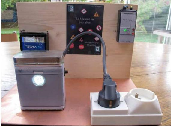
Recommencez en branchant l'appareil sur la prise sans terre. Que le bouton « défaut » soit sur « non » ou sur « oui », la DEL du lave-vaisselle reste allumée, l'appareil semble fonctionner correctement.
