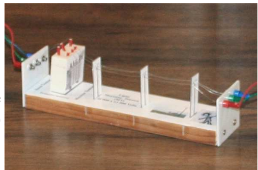
Le transformateur THT / MT et la ligne Moyenne Tension (MT)
