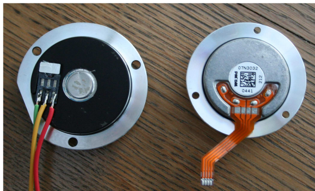
Trois bornes de sortie Branchement « triangle »
