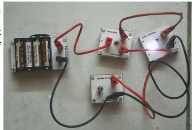
Conclusion : l'inverseur agit, pour le courant électrique, comme un aiguillage pour les trains.
