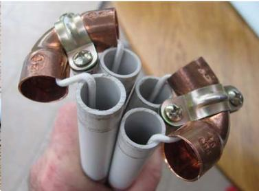
Solidarisez les 4 tubes (95,5 cm) et les 4 colliers constituant la base de la structure en y installant un caoutchouc de 2 à 3 mm de diamètre légèrement tendu.
