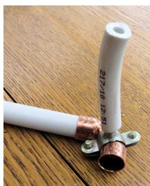
Les tubes plastique électricité de 95,5 cm doivent être placés dans les coudes de cuivre (base et dessus de la structure), alors que les tubes de 96,5 cm constitueront les côtés verticaux de cette dernière.
