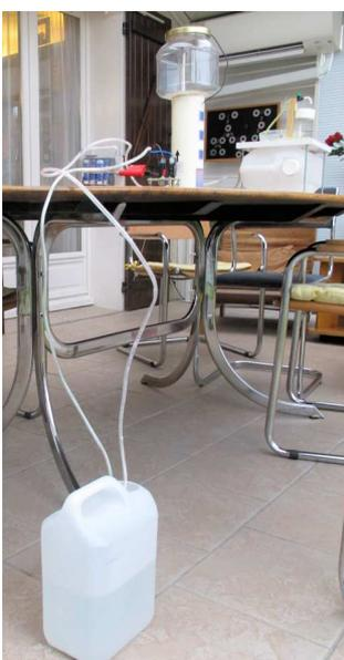
Placez la pompe dans le bidon figurant la nappe phréatique ou le réservoir de sortie de l'usine de traitement de l'eau potable, branchez-la sur le bloc pile 12 Volts en insérant un interrupteur dans le circuit.
