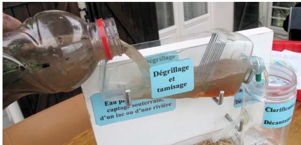
Les éléments grossiers (branches par exemple) sont arrêtés par la grille, le reste coule dans le bassin de décantation.
