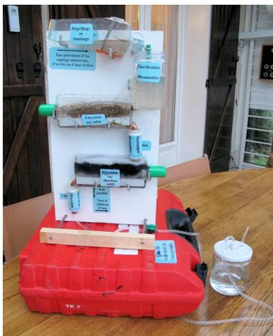
A la sortie de l'unité de chloration, on placera un récipient pour recueillir l'eau traitée et l'envoyer vers une zone de stockage ou directement dans le château d'eau.
