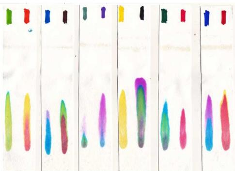
L'eau va monter par capillarité dans le papier filtre et entraîner les colorants à des vitesses différentes suivant leur composition chimique, ce qui entraînera leur séparation.
