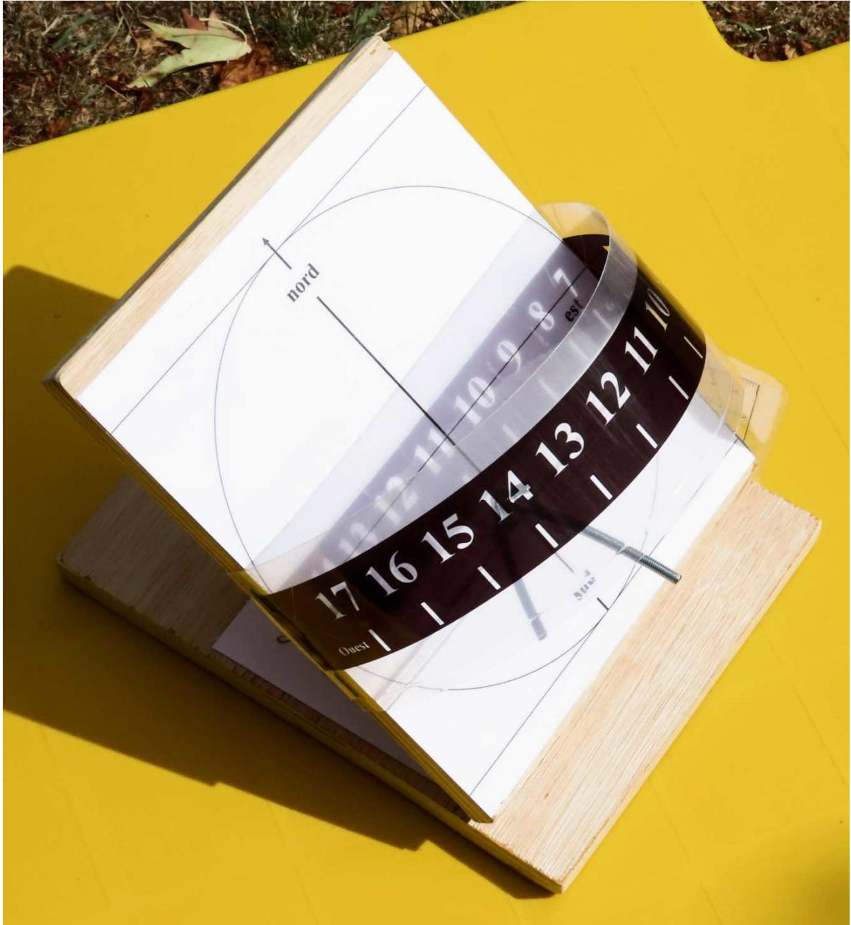
Après orientation du cadran et réglage de l'inclinaison en fonction de la latitude et de la date, l'ombre portée de la pièce semi cylindrique sur le support vous indiquera l'heure (solaire) au niveau de la ligne Nord-Sud.
