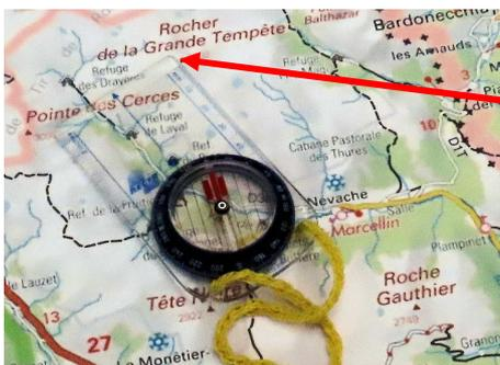
Placez la boussole sur la carte, un des grands côté de la boussole sur la représentation du point visé carte, l'aiguille rouge sur le point N du cadran. La position de l'observateur est quelque part sur la ligne définie par le grand côté de la boussole. Avec un crayon, on trace cette ligne sur la carte.
