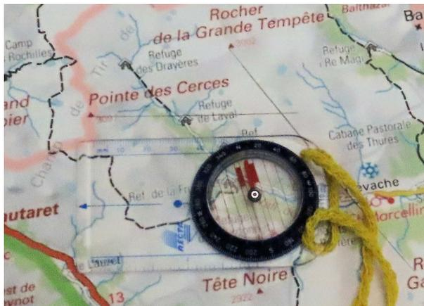
On recommence avec un deuxième point remarquable et on trace une deuxième ligne sur la carte. En théorie, si les visées sont parfaites, l'observateur doit se trouver à l'intersection des deux lignes... mais dans la réalité les mesures ne sont jamais parfaites.
