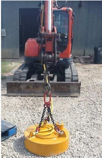
Ces électro-aimants, montés sur une grue à la place du crochet permettent de déplacer rapidement des ferrailles avec un minimum de manipulation, ce qui permet de gagner du temps.
