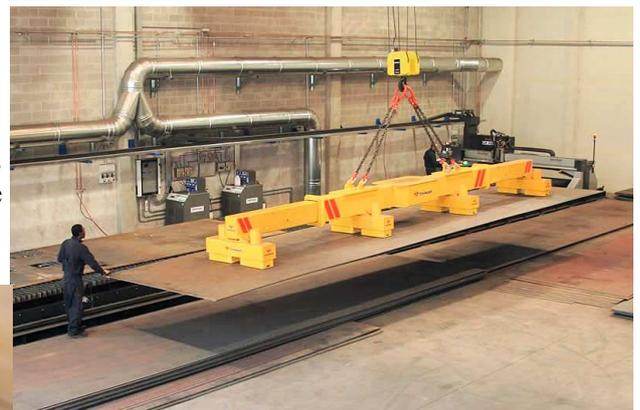
Dans des usines qui utilisent de grandes plaques d'acier, des portiques munis d'électro-aimants permettent de déplacer ces plaques rapidement et sans les déformer.
